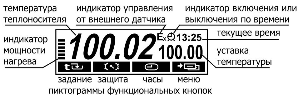
Рисунок 3 — Дисплей в режиме регулирования по уставке
